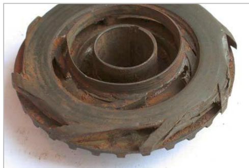
Рис. 1. Износ осевых уплотнений РК
