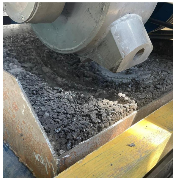
Рис. 2. Установка для испытаний на износ
