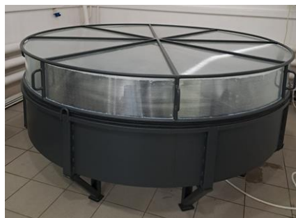
Рис. 1. Круговой почвенный стенд конструкции ФНАЦ ВИМ
