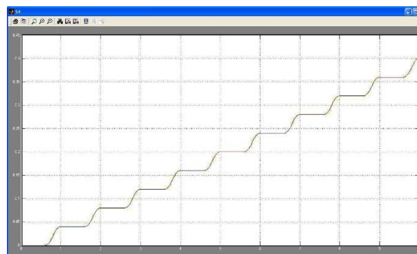
Рис. 7. Результаты моделирования перемещения тела трения от времени при малых скоростях скольжения
