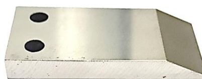
Рис. 2. Фото опытного образца лезвийного почворезущего рабочего органа
