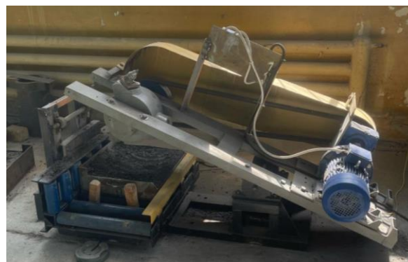
Рис. 1. Установка для испытаний на износ
