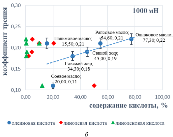
Рис. 1. Зависимость коэффициента трения от содержания жирных кислот: а – нагрузка 100 мН; б – нагрузка 1000 мН
