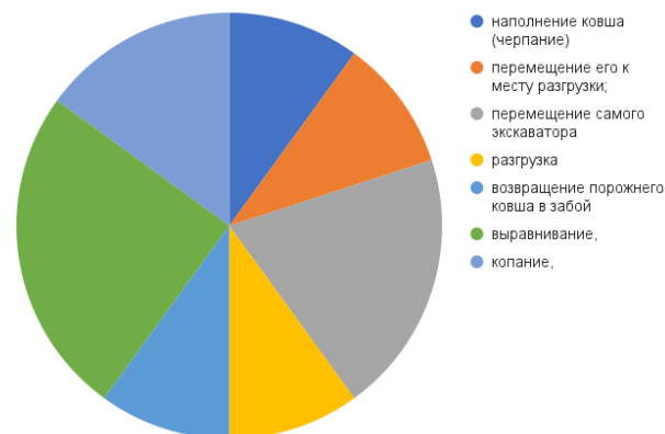
Рис. 2. Распределение времени работы экскаватора по режимам (ориентировочное)
