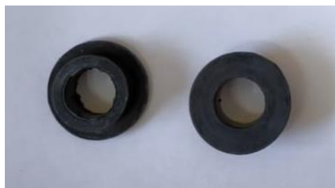
Рис. 1. Образец исследуемого резинотехнического изделия фильтра тонкой очистки топлива МТЗ, ЮМЗ, Т-40
