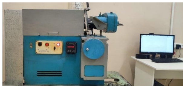
Рис. 2. Модернизированная машина трения СМЦ
