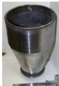
а — образец вала, полученного из листа сплава ЭИ962-Ш
