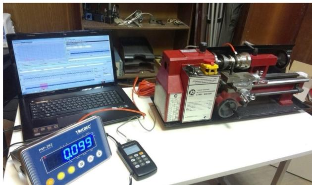
Рис. 124. Измерение вибрации шпиндельного узла при нагружении осевой силой
