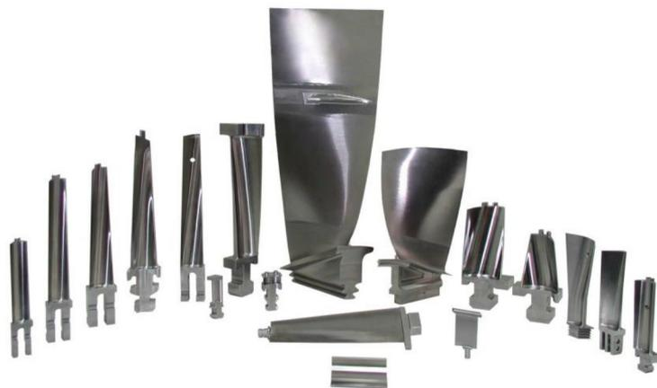
Рис. 88. Типовые конструкции лопаток авиационных двигателей
