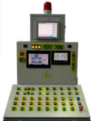
Рис. 10. Пульт управления с дисплеями технолога и оператора
