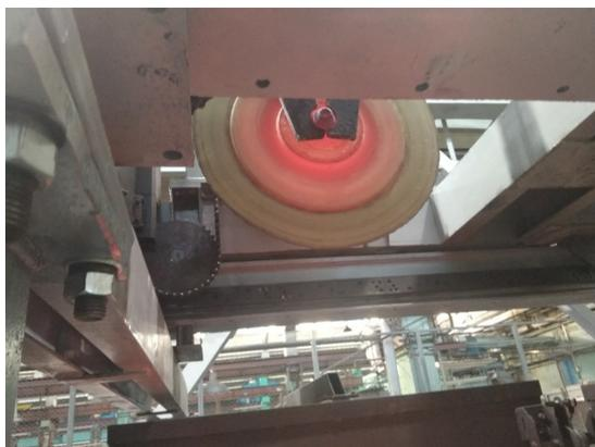
Рис. 19. Транспортировка манипулятором раскатанной заготовки в камеру для термообработки
