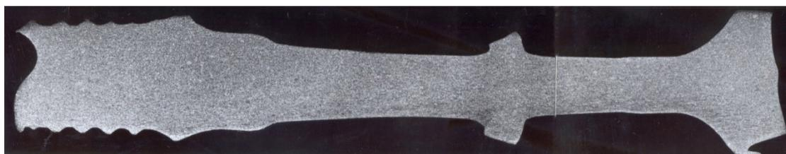
Рис. 14. Макроструктура раскатанного диска из сплава ЭП742 при  $1050\text{ }^{\circ}\text{C}$  ( $\gamma + \gamma'$  - области)
