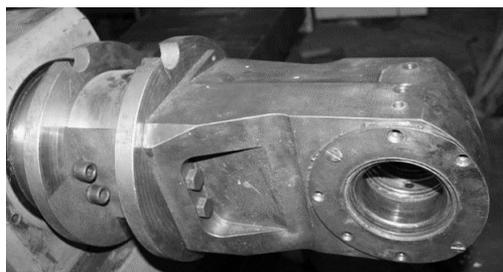
Рис. 33. Охлаждаемая кассета для ролика
