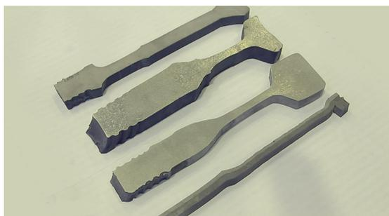
Рис. 12. Образцы диска (разрезы) с однородной структурой (материал ВТ6)
