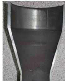
Рис. 39. Полый вал, раскатанный из листа сплава ЭИ962-Ш
