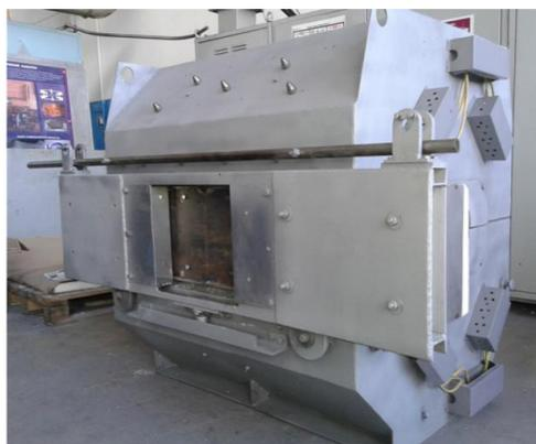
Рис. 30. Печь нагрева с подвижной створкой для продольного перемещения инструментального узла
