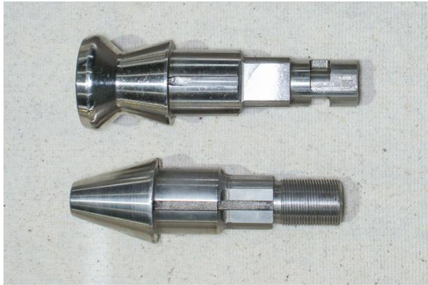
*Рис. 26. Набор инструментальных роликов из жаропрочных сплавов*
