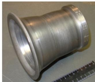
б — образец вала из штампованной заготовки из сплава ЭК79
