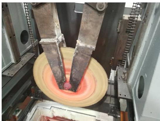
Рис. 18. Выгрузка раскатанной заготовки из рабочей печи
