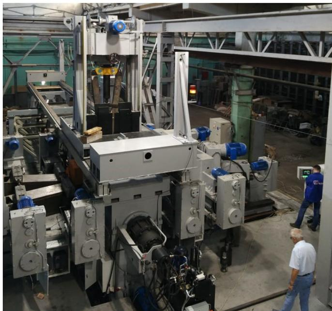
Рис. 16. Загрузка манипулятором разогретой до 1150 °С заготовки в рабочую печь
