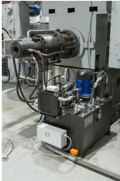
Рис. 22. Гидростанция управления пинолями зажима заготовки
