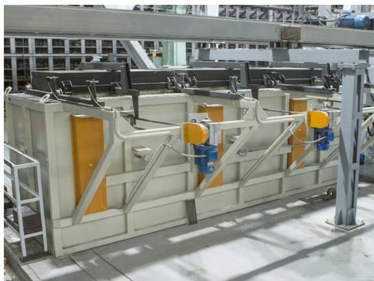
Рис. 20. Печь предварительного нагрева (3 камеры)
