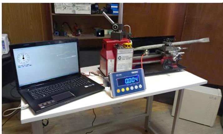
Рис. 114. Измерение жесткостных параметров шпинделя
