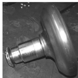
Рис. 34. Инструментальный ролик
