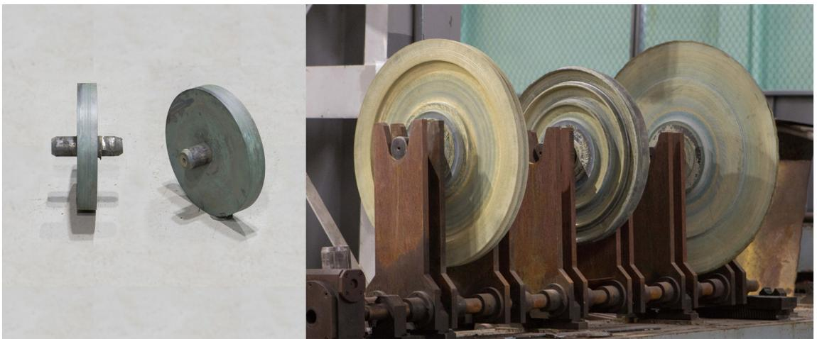
*Рис. 27. Исходная заготовка из сплава ВТ9  $\varnothing 400$  мм, толщина 60 мм*
