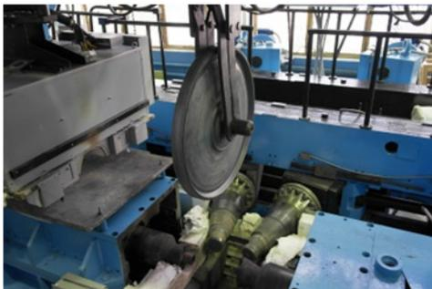
Рис. 2. Транспортировка заготовки манипулятором
