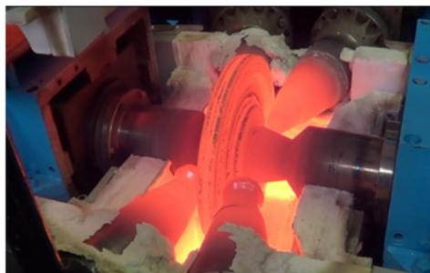
Рис. 4. Раскатка заготовки в печи нагрева
