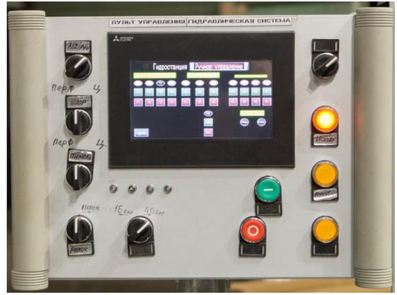
Рис. 21. Блок управления камерами предварительного нагрева и пульт управления линией
