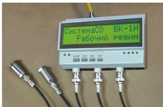
Рис. 125. Комплекс приборов для оперативной диагностики шпиндельных узлов
