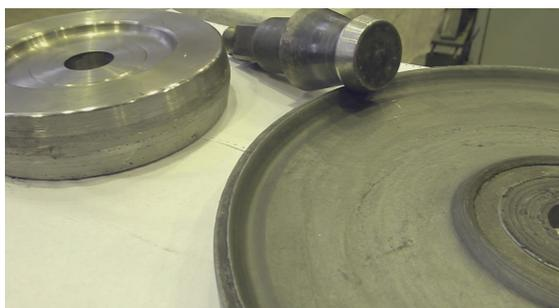
Рис. 11. Примеры раскатанных деталей на СРЖД-800 (материал ВТ6)
