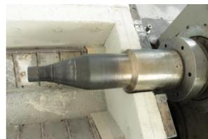
Рис. 32. Охлаждаемый шпиндельный узел
