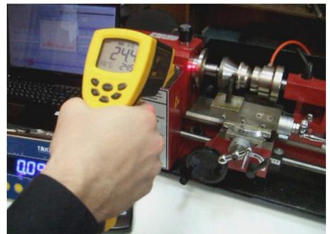
*Рис. 111. Измерение температуры передней опоры шпиндельного узла*
