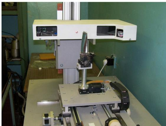
Рис. 100. Оптическая система контроля геометрических параметров пера лопаток
