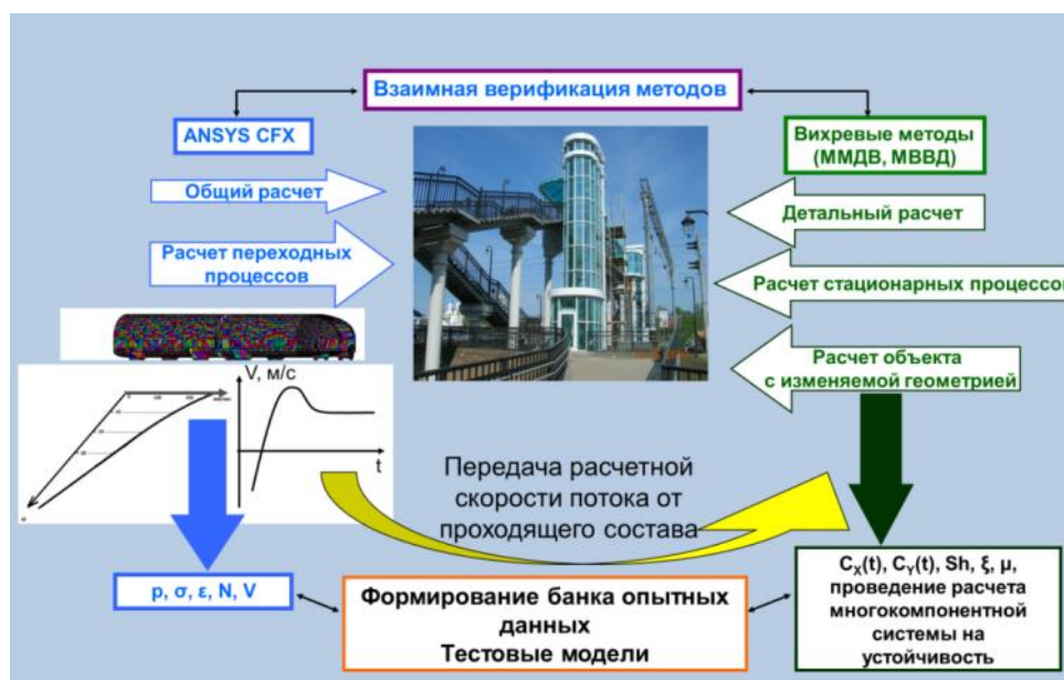
Рис. 1. Блок-схема проведения исследований гидроаэродинамических воздействий на конструкции и объекты энергетического и транспортного машиностроения.
