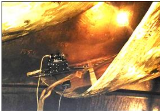
Рис.3. Спекл-интерференционная установка, расположенная на лопасти турбины.
