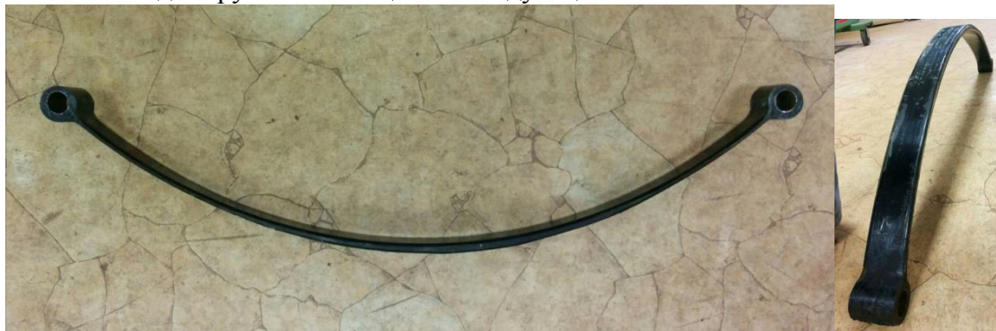
Рис. 1. Продольная композитная рессора автомобиля, выбранная для отработки методики расчета
