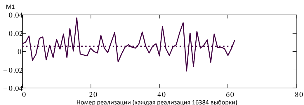
Рис.3. Зависимость первого статистического момента от времени для последовательности реализаций (пунктир –линейная регрессия оценок).
