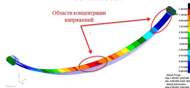
Рис. 5. НДС рессоры автомобиля. Напряжения вдоль оси X
