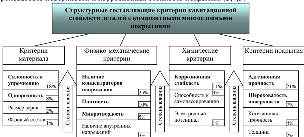
Рис. .1 Структурные составляющие критерия кавитационной стойкости деталей с композитными многослойными покрытиями, (в % указана относительная степень влияния критерия в общей структуре, жирным выделены преобладающие критерии)
