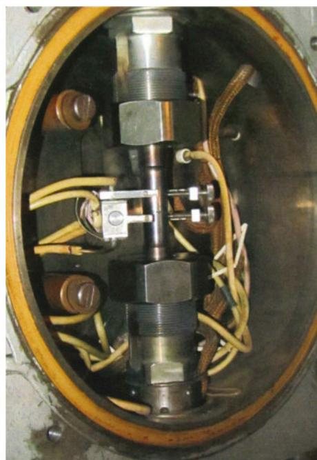
Устройство для нагружения образцов, используемое в установке для испытаний на малоцикловую усталость в вакууме
