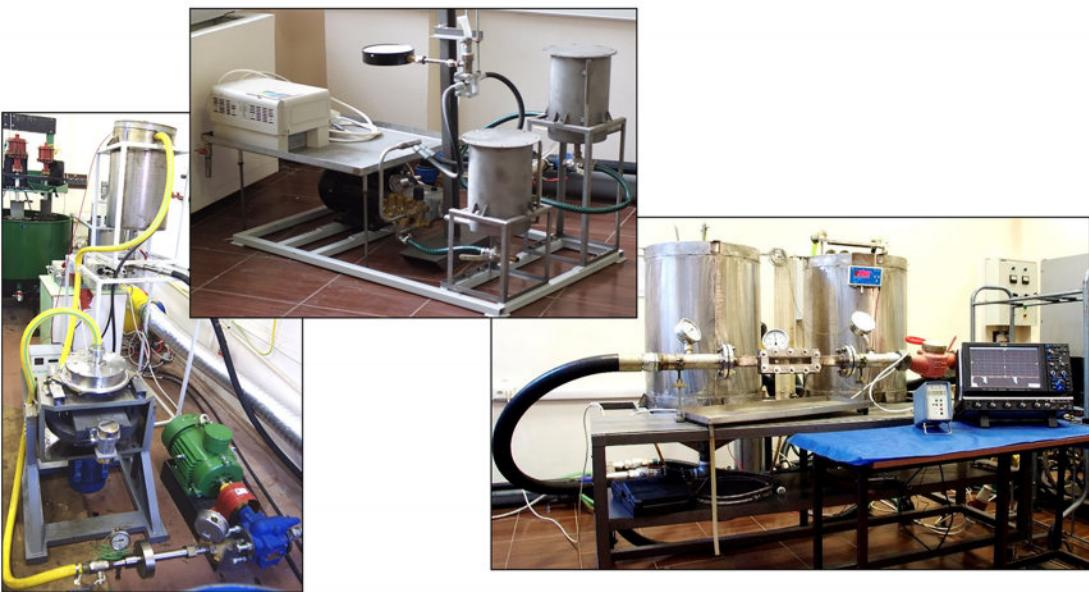
Технологические линии для кавитационно-волновой обработки жидких сред (тонкое и сверхтонкое измельчение, смещение и диспергирование суспензий и эмульсий)
