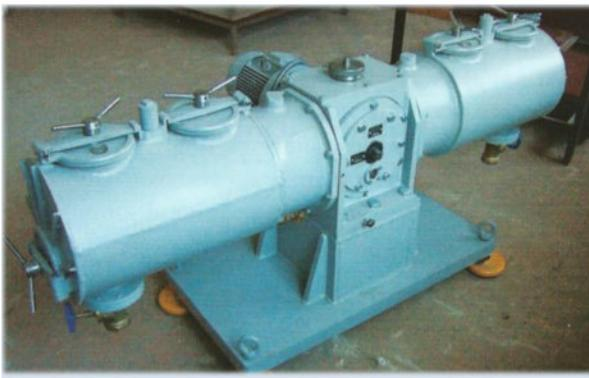
**Волновая установка для очистки и полировки поверхностей деталей газожидкостной моющей средой**
