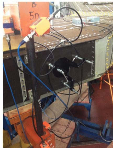
*Исследование кинетики повреждений в зоне технологического окна стенки лонжерона акустико-эмиссионным методом*
