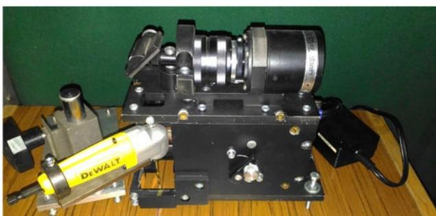
*Специализированный мобильный спектр-интерферометр для экспериментального исследования НДС и определения остаточных напряжений в натурных условиях*
