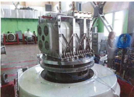
Натурные испытания прибора Френд (проект ЭкзоМарс) на вибrostенде по заданному спектру возбуждения
