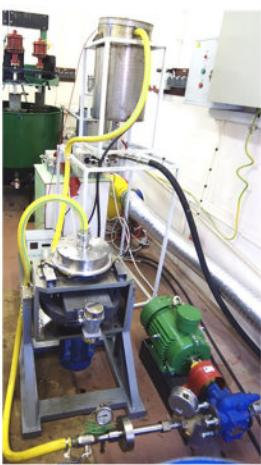
Лабораторный стенд для кавитационно-волновой обработки сверхвязкой нефти
