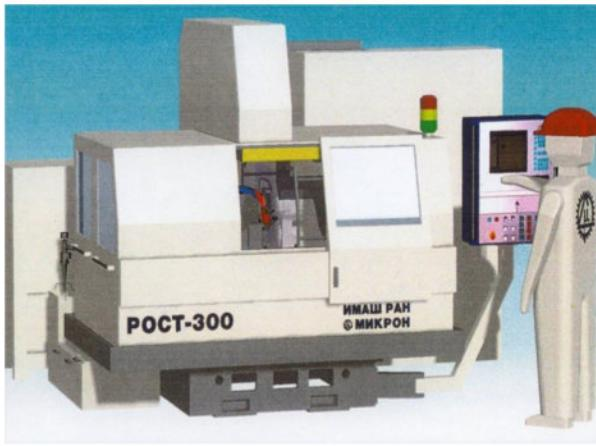
**Робот-станок для финишной обработки пера лопаток турбин**
