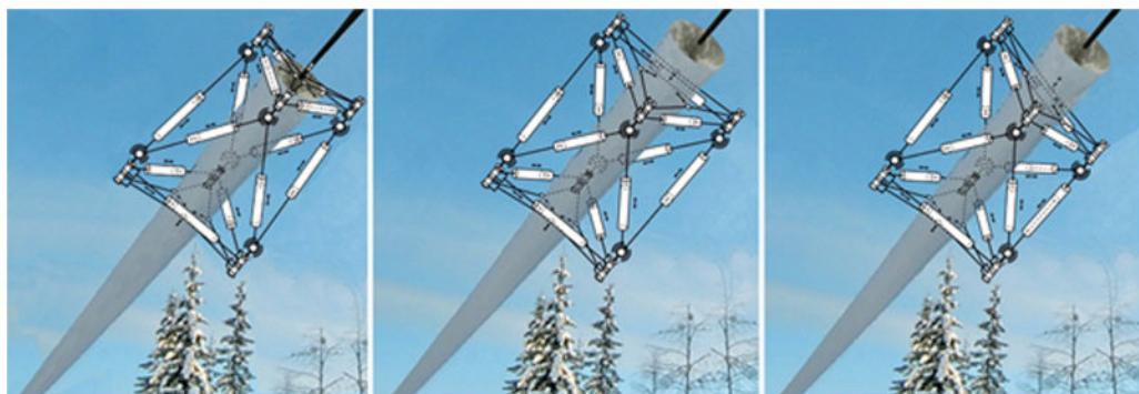
*Самопрелемещающийся параллельный робот для обслуживания и ремонта ЛЭП*
