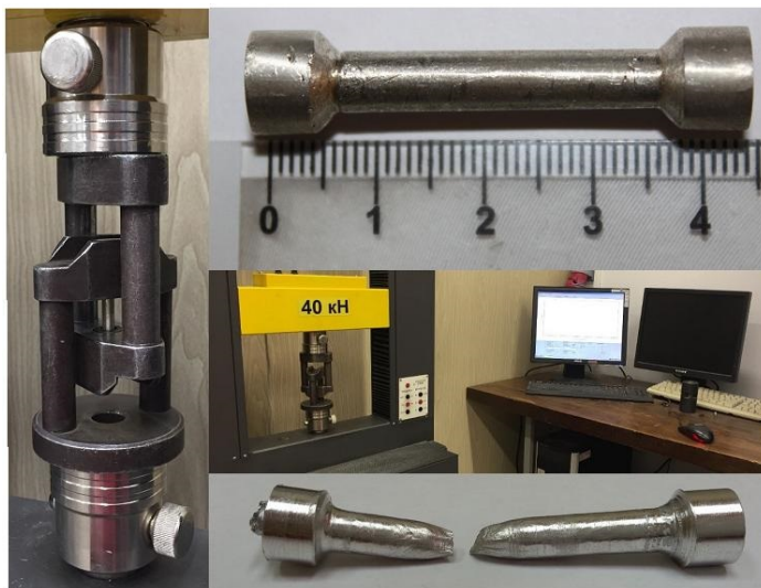
Рис.10. Исходный образец, разрывная машина МИ-40КУ, образец после разрушения
