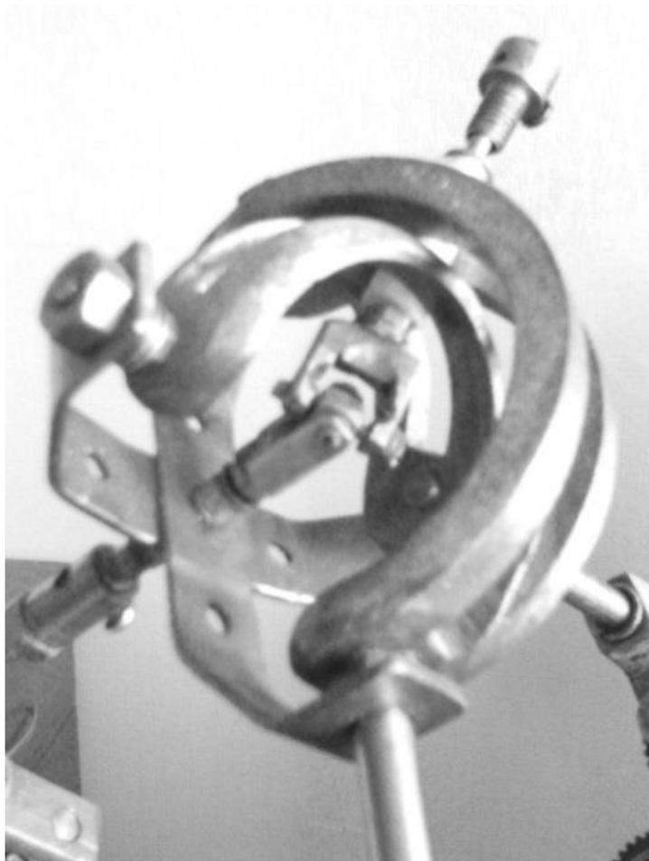
Рис.8. Сферический механизм макета
