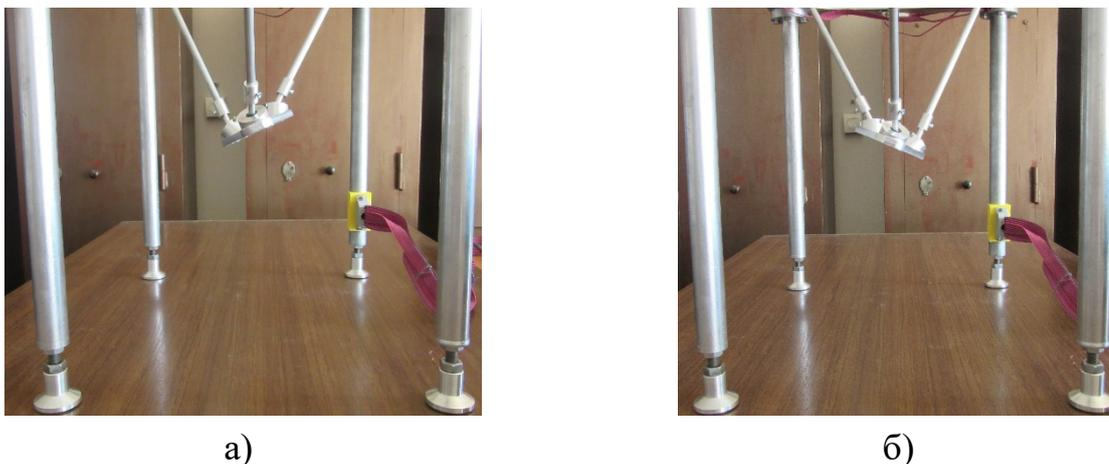
Рис. 5.23. Минимальное (а) и максимальное (б) значения угла ориентации  $\psi$
