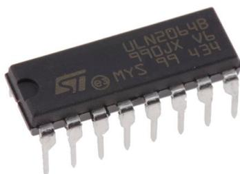
Рис. 5.4. Микросхема ULN2064В
