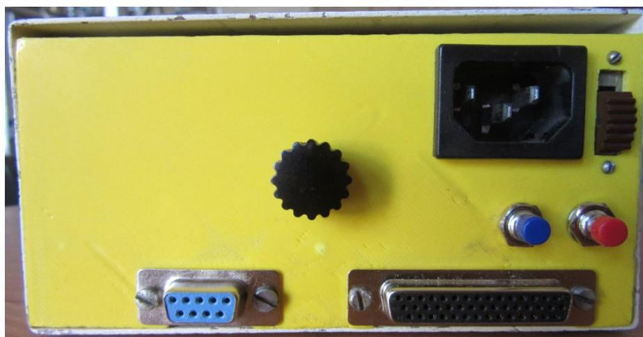
Рис. 5.14. Задняя панель блока управления
