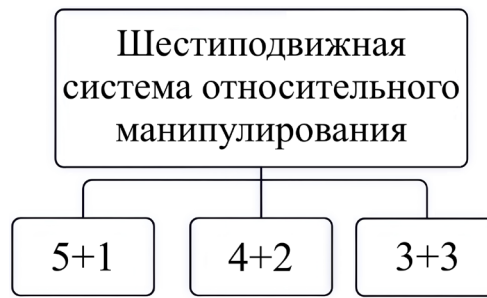
Рисунок 1.1 – Схематичное обозначение шестиподвижных групп механических систем относительного манипулирования
