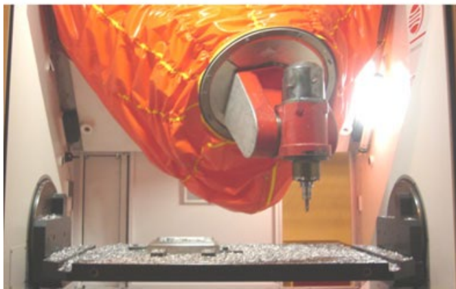
Рисунок 1.16 – Шестиподвижная система относительного манипулирования Tripteor X7 с пятиподвижным и одноподвижным модулями для операций фрезерования/сверления
