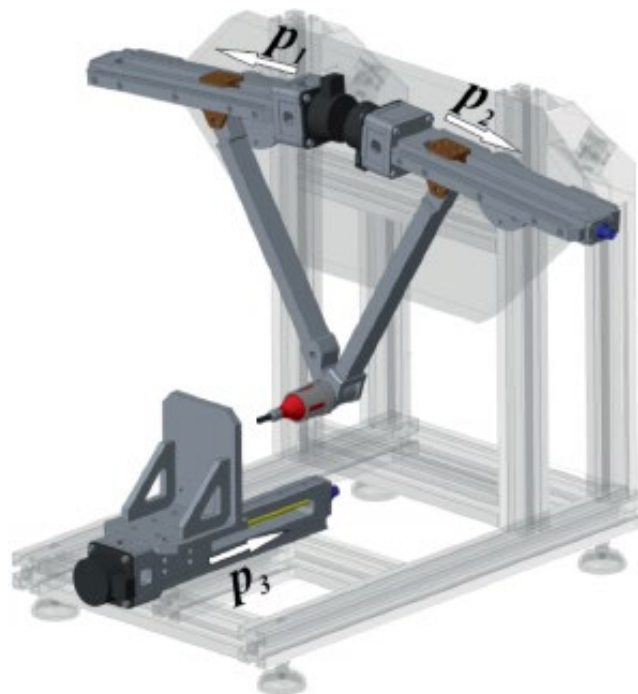
Рисунок 1.3 – Реконфигурируемый двухподвижный плоский механизм параллельной структуры
