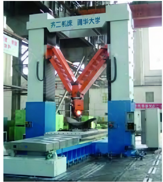
Рисунок 1.7 – Пятиосевой станок в виде механической системы относительного манипулирования: компьютерная модель (слева) и прототип (справа)
