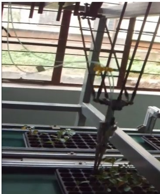
Рисунок 1.2 – Трехподвижный высокоскоростной робот относительного манипулирования для пересадки рассады
