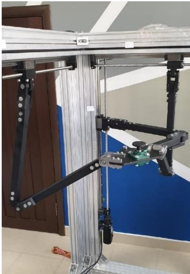
Рисунок 4.8 – Экспериментальный образец механизма для реабилитации нижних конечностей
