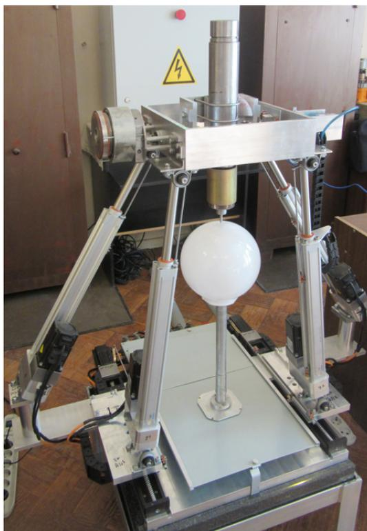
Рисунок 1.17. Прототип устройства для позиционирования лазерной головки
