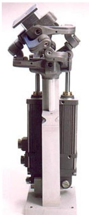
Рисунок 1.3. Механизм ориентации Omni-Wrist
