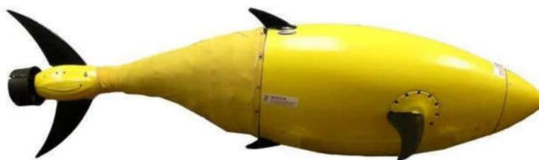
Рис. 1.20. Необитаемый автономный подводный робот «BioSwimmer»,
