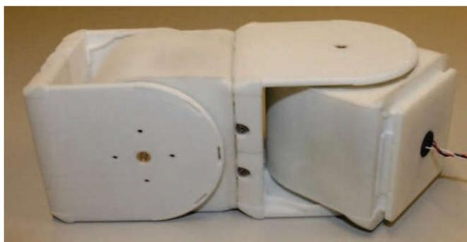
Рис. 1.10. Модуль робота - змеи
