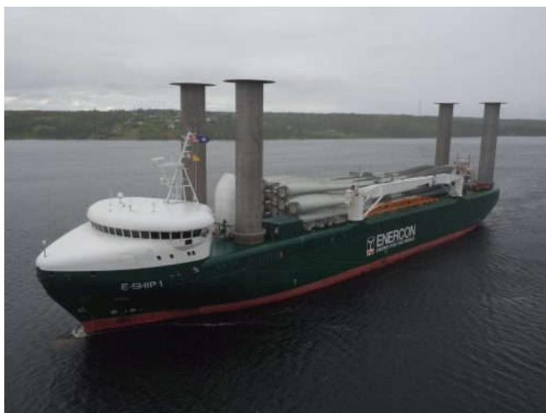
Рис. 1.21. Грузовое судно E-SHIP1 с четырьмя роторами Флеттнера
