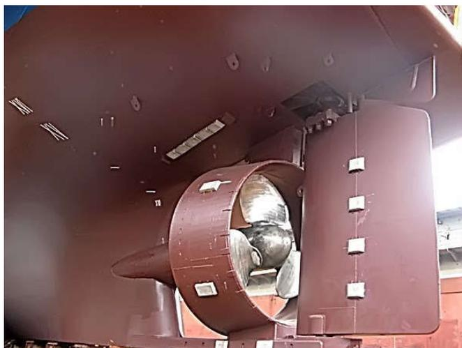
Рис. 1.1. Гребной винт и управляемый руль
