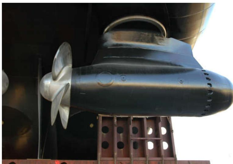
Рис. 1.3. Винто-рулевая колонка
