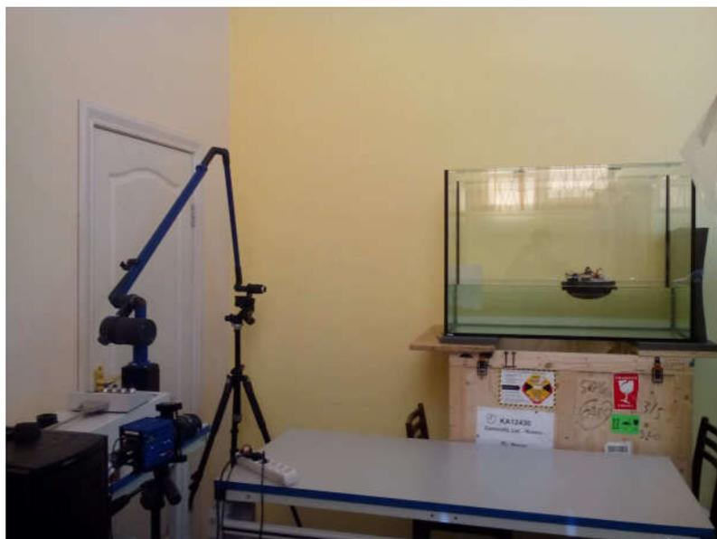
Рис. 4.3. Экспериментальная установка исследования течения жидкости вокруг БНР методом PIV
