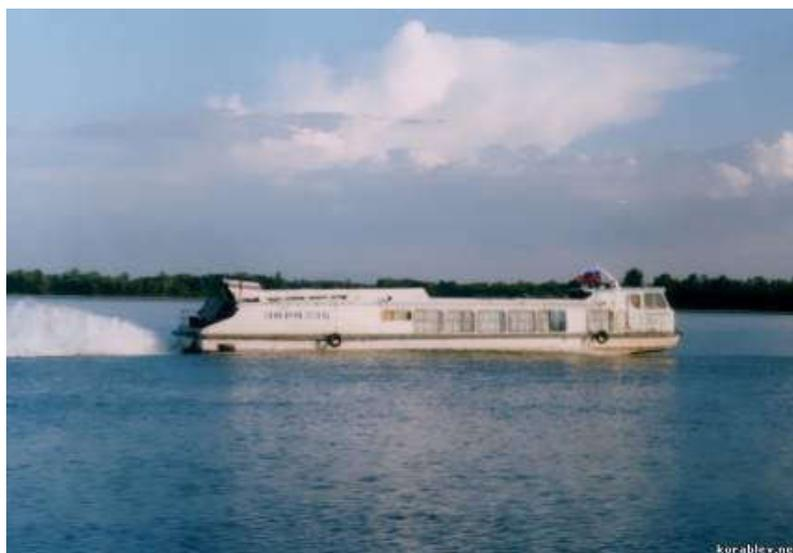
Рис. 1.16. Теплоход типа «Заря» проекта 946 с водометным движителем
