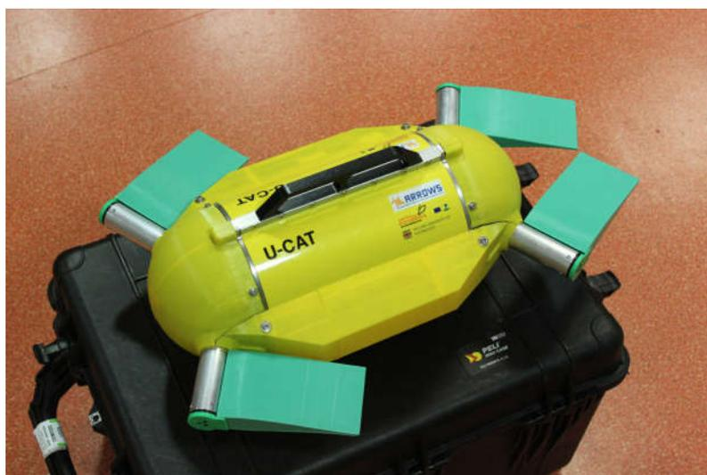
Рис. 1.4. Необитаемый автономный подводный робот U-CAT
