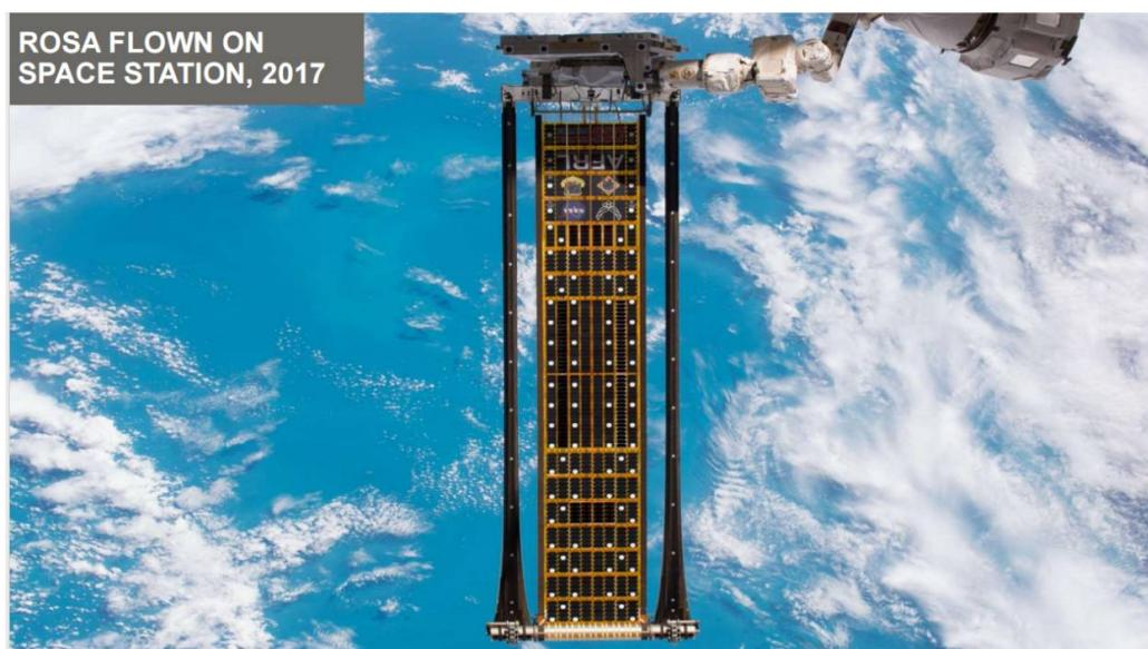
*Рисунок 1.1 – ПСБ ROSA в развёрнутом состоянии в составе МКС*
