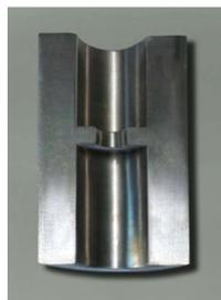
Рис. 2. Срез выдавленного образца из стали 12Х18Н9Т.
