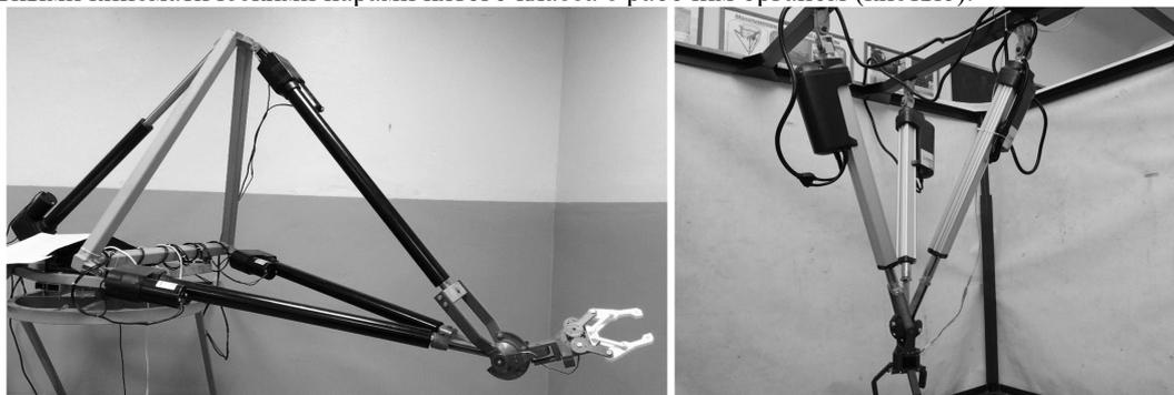
Рис.1. Манипуляторы параллельно-последовательной структуры на основе трипода.
