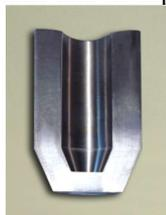
Рис. 2. Срез выдавленного образца из стали 12Х18Н9Т.
