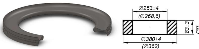
Рис. 1. 3D-модель и эскиз армирующего кольца сильфона.
