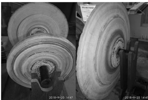
Рисунок 1. Образцы дисков, раскатанных из титанового сплава VT-9.
