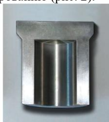
Рис. 2. Срез выдавленного образца из стали 12Х18Н9Т.
