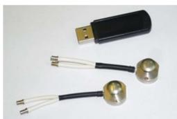
Рис. 1. Волоконно-оптические датчики пульсовой волны.
