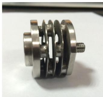
Рис.1 Образец прототипа метаматериала из фотополимера для исследований акустических свойств на установке «труба Кундта» (слева) и образец виброизолятора в виде набора тонких пластинок «шайб», соединенных в шахматном порядке, с шунтирующими свойствами в диапазоне частот 400-600Гц (справа).
