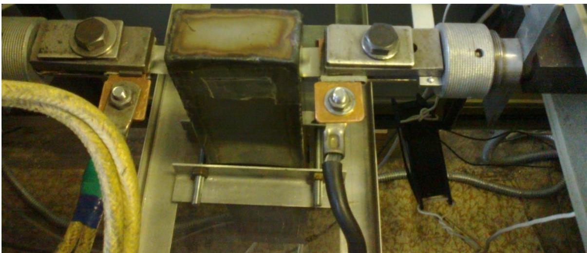
*Рис. 4 Испытуемый образец находится внутри волновода, магнетрон в низу. ЭМ поле  $E$  направлено поперек оси образца. Через токоподводы подводится импульсный ток*
