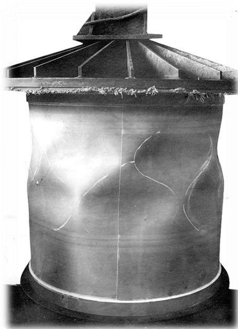
*Рис. 1. Потеря устойчивости трёхслойной оболочки с пенопластовым наполнителем при осевом сжатии*
