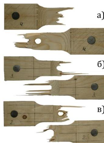
Рис.6. Разрушение образцов
