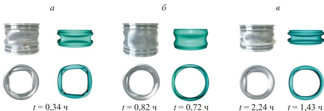
Рис. 2. Формы выпучивания «коротких» оболочек, полученные в эксперименте (слева) и при компьютерном моделировании (справа): а – образец 4 ( $\sigma = 10$  МПа), б – образец 6 ( $\sigma = 7,5$  МПа), в – образец 7 ( $\sigma = 6,0$  МПа),  $t$  – критические времена выпучивания.
