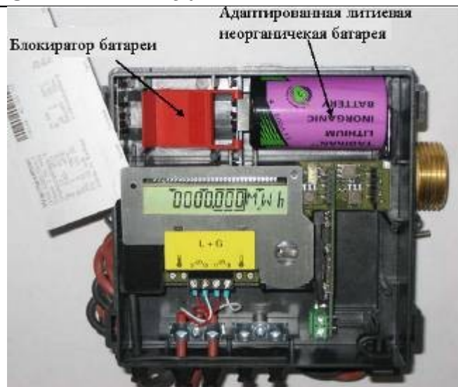
Рисунок 6в. Внутренний вид прибора ULTRAHEAT 50(отсек батареек)
