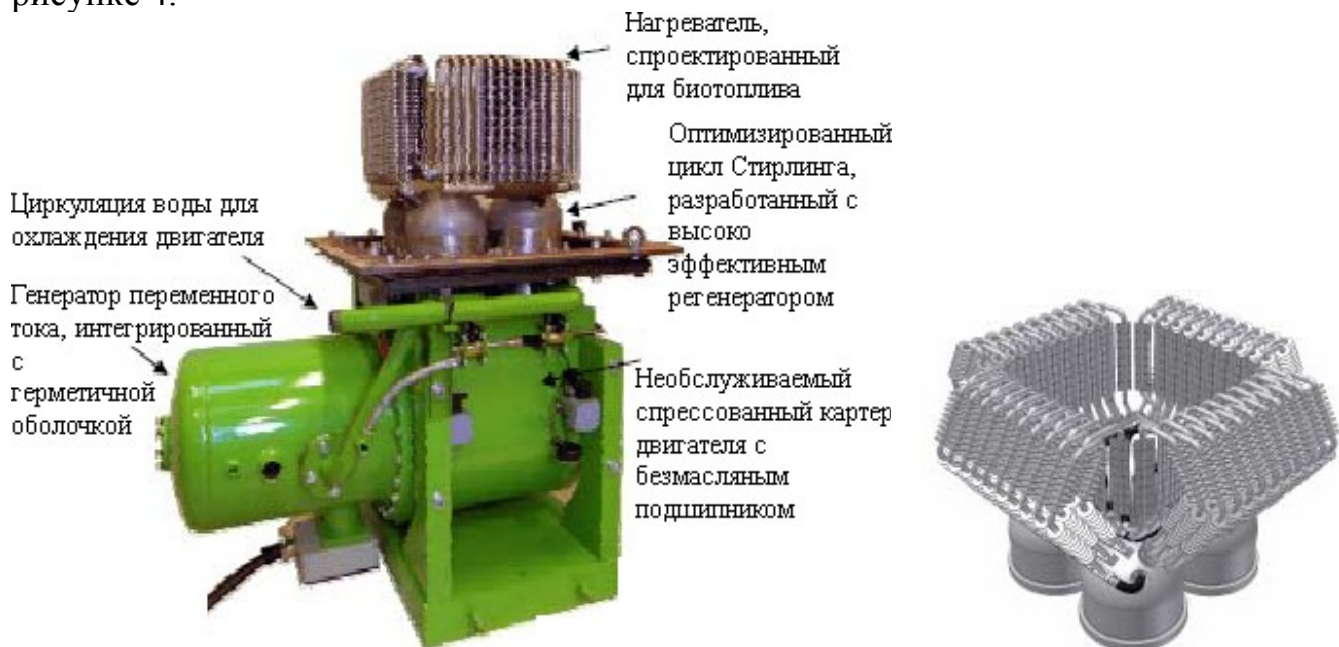
Рисунок 4. Узловые моменты двигателя Стирлинга на 35 кВт(слева) и, в частности, его нагревателя для биотоплива(справа).
