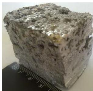
*Рис. 1 - Образец пеноалюминия, полученный в настоящей работе. Размер 40x35x35 мм. Преобладает сферическая форма пор, их размеры находятся в диапазоне 0,5...10 мм, и они равномерно распределены по объему металла. Образец имеет кажущуюся плотность  $0,83 \text{ г/см}^3$ , пористость 70%, предел прочности на сжатие составляет 3,8-4,2 МПа.*
