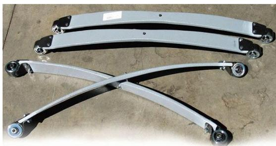
*Рис. 1. Стеклопластиковые рессоры – «ангрейд» на «Джип Ранглер» для продвинутых путешественников*
