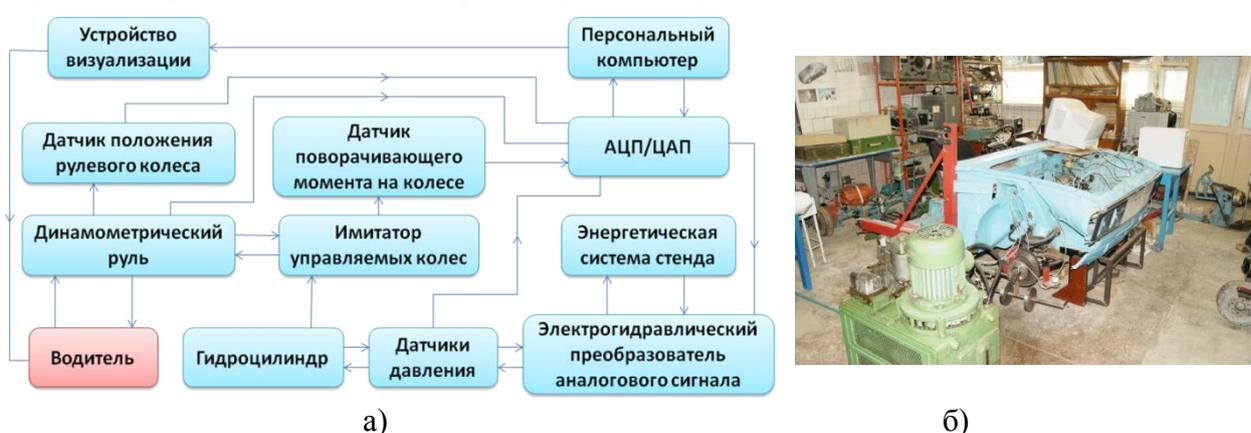
Рис. 1. Лабораторный стенд: а) принципиальная блок-схема комплексной моделирующей установки; б) общий вид комплексной моделирующей установки
