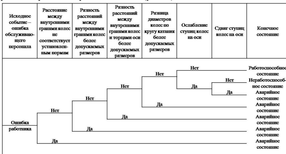
Рис. 1 – Дерево событий для случая схода вагона с рельсов при неисправности колесных пар вагонов
