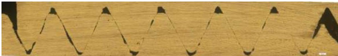
Рисунок 11 – Снимок конической резьбы после её нагружения
