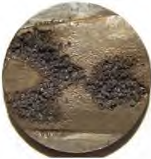
Рис. 5. Фотография следов кавитационной эрозии на контрольном образце при максимальном уносе и
