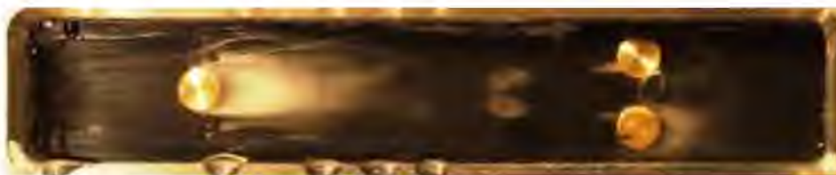
Рис. 3. Фрагмент картины визуализации кавитационных зон в канале волнового генератора при P_{\text{вх}} = \text{const} , P_{\text{вых}} = \text{var}
