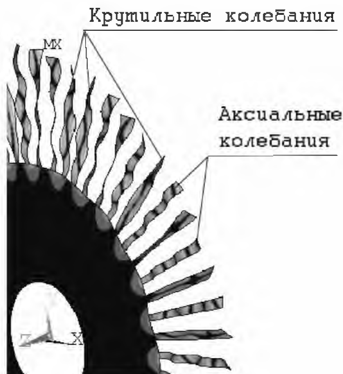
Рис. 16. Форма колебаний модели диска с лопатками при числе узловых диаметров n=14
