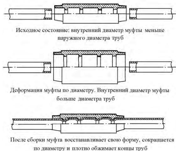
Рис.2 Схема образования неразъемных соединений муфтами ТМС
