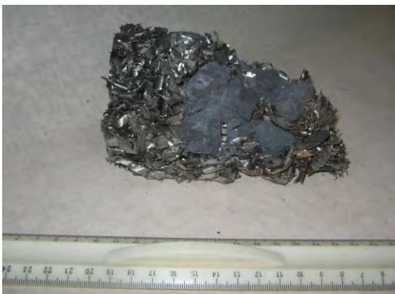
Рис. 4. Фотография фрагмента композитного брикета из стружки стали Ст. 3 с добавкой кусков материала с малой электропроводностью (горной породы). Размер брикета: 200x60x60 мм; плотность 1,4 г/см<sup>3</sup>; масса 1 кг (400 г стружки и 600 г породы).
