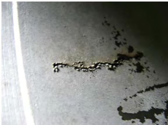
Рис. 4. Вскрытая приповерхностная пора в результате вакуумно-дуговой очистки корпуса буксы железнодорожного вагона.
