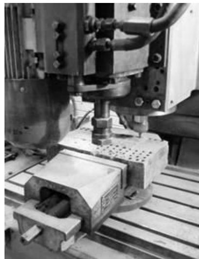
Рис. 1. Блок синтегрانا на обрабатывающем центре во время его обработки
