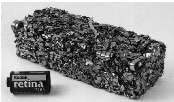
Рис. 3. Фотография пробного брикета. Стружка титанового сплава 3М. Размер брикета: 175x64x50 мм; плотность 1,1 г/см<sup>3</sup> (пористость 75%); масса 590 г
