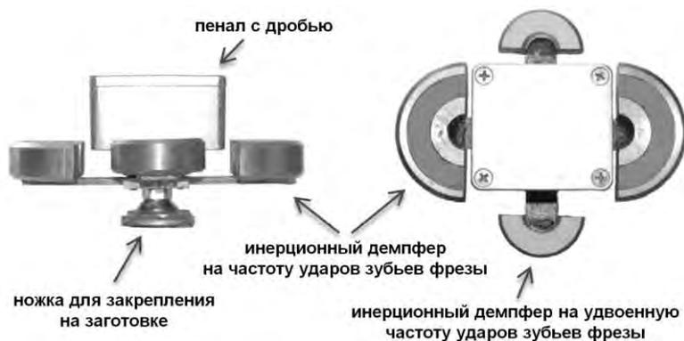
Рис. 2. Разработанный прототип демпфера для фрезерования нежестких заготовок
