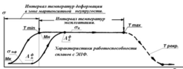
Рис.1. Зависимость реактивных напряжений, возникающих в материале при термическом формовосстановлении в условиях противодействия от температуры:
