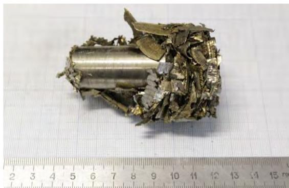
Рис. 5. Фотография фрагмента брикета из стружки высокопрочного титанового сплава BT20 с добавлением крупных кусков титана с размером: диаметр: 20 мм, длина: 48 мм, массой 68 г. Размер брикета: диаметр 50 мм, высота 90 мм; масса 215 г плотность 1,2 г/см<sup>3</sup>
