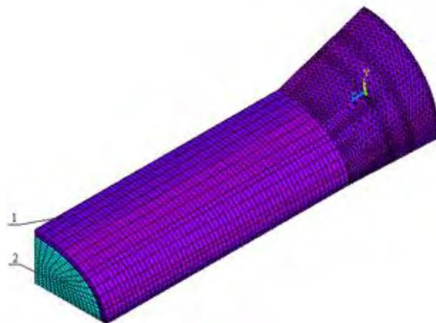
Рисунок 2 Конечно-элементная модель упругой камеры стабилизатора волновых процессов с постоянным внешним нагружением: 1 – стальная упругая камера, 2 – полиуретановый наполнитель (показана ¼ сечения и половина длины камеры)
