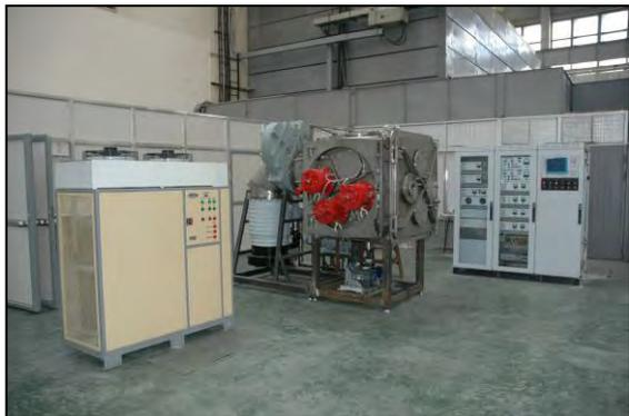
Рис.5 Общий вид установки «Радуга» для ВИП обработки конструкционных материалов.
