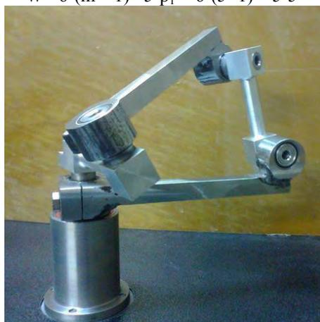
Рис. 8. Фотография лабораторно-экспериментальной установки двухподвижного пространственного 5R-механизма, синтезированного на базе 4R-механизма предлагаемым способом
