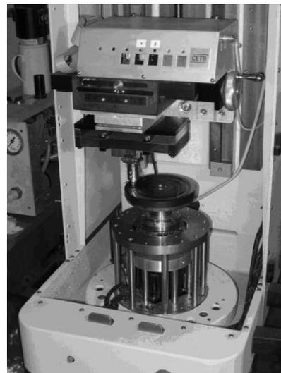
Рис. 1. Фотография трибометра UMT-2
