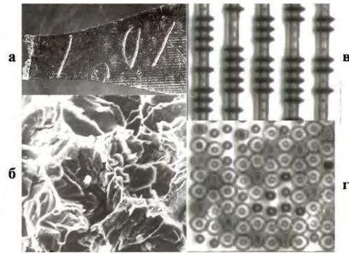
Рис. 6 ВКМ с высокой прочностью соединения матричного материала с волокнами: а – образец после испытаний на растяжение; б – снимок с поверхности разрушения, сделанный на электронном микроскопе; в, г – фрагменты с экрана монитора, наблюдаемые при имитации процесса разрушения на компьютере, соответственно, в продольном (вдоль волокон) и поперечном (перпендикулярно волокнам) сечениях композита.
