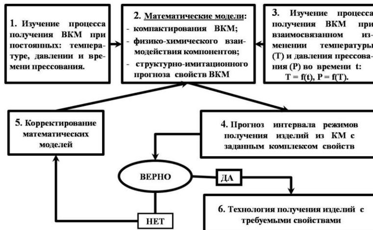
Рис. 7 Блок-схема оптимизации режимов получения ВКМ с требуемыми свойствами на основе использования расчетных методов.
